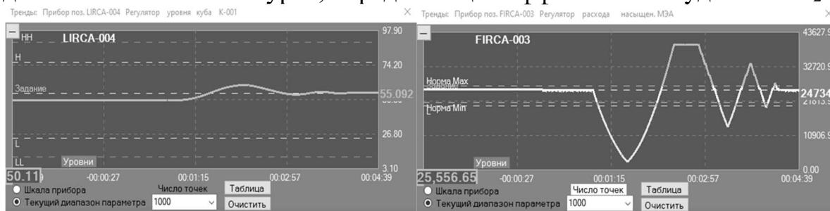
Рис. 3. Взаимосвязь уровня раствора МЭА в колонне и расхода отвода насыщенного МЭА при каскадном регулировании
